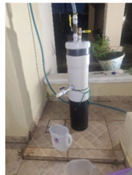
Figura 2. Permeámetro en funcionamiento
