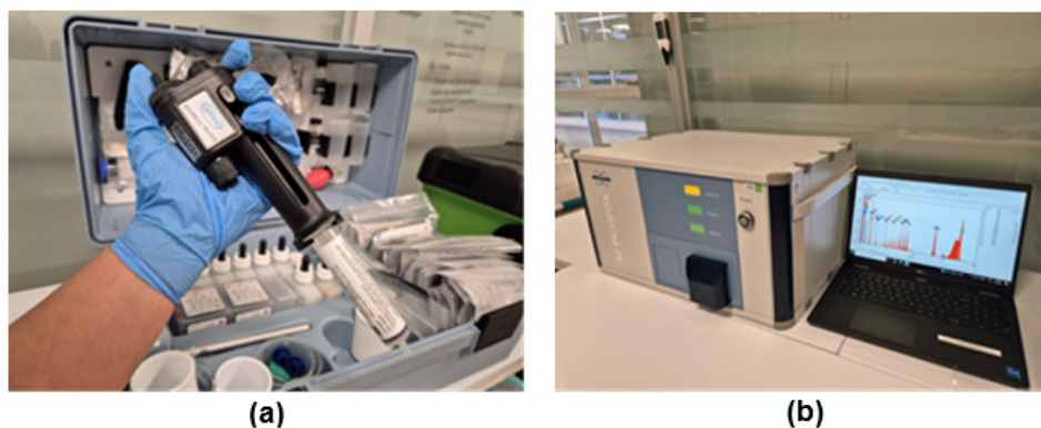
Fig. 1 Equipos de calidad de agua. (a) Titulador Digital HACH; (b) Espectrómetro TXRF S2Picofox.
