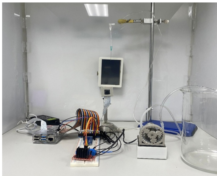
Fig. 1. Prototipo de una estación de ajuste del menisco para matraces.
