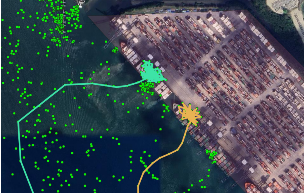
Ilustración 1. Representación del Puerto de Balboa (PABL), mostrando la geocerca definida y las trayectorias de buques compuestas por puntos AIS.
