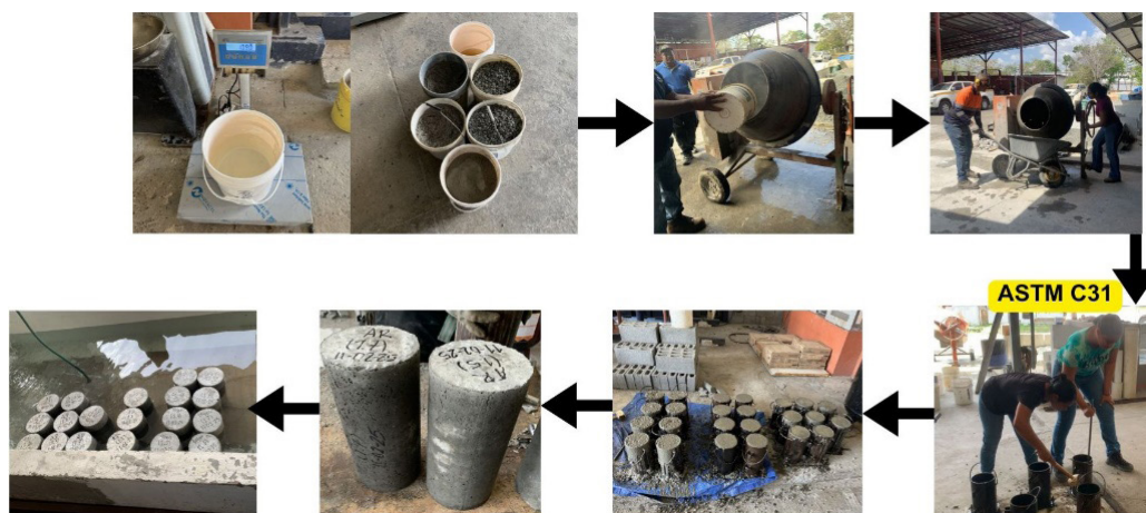
Fig. 3. Procedimiento de elaboración de especímenes.
